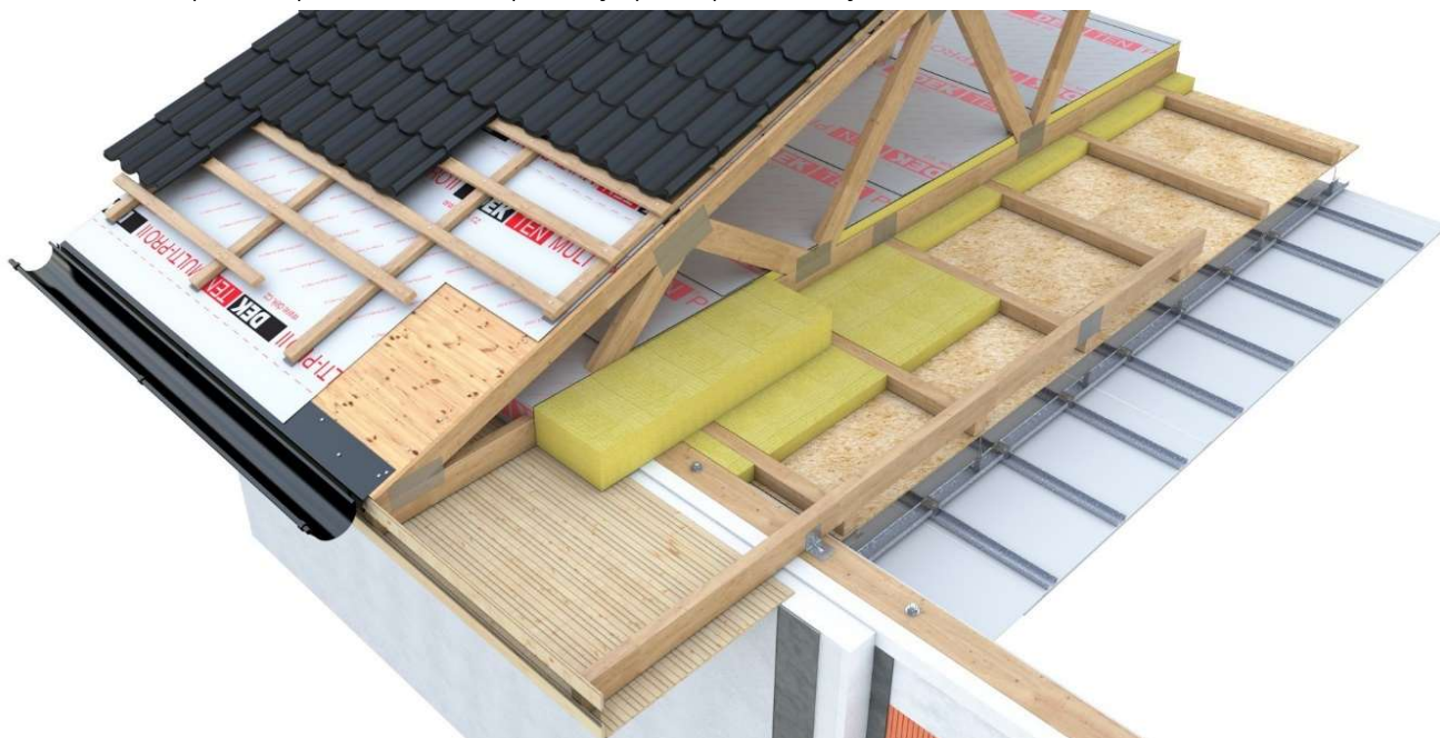
Obrázek č. 4.9.3: Zateplení stropu minerální vlnou pod nevytápěnou půdou (Zdroj: izolace-info.cz)
